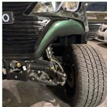
Bağımsız Çift Salıncaklı Süspansiyon
