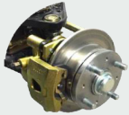
4 Tekerlek Hidrolik Disk Fren, Elektronik Park Freni, Yokuş Kalkış Desteği (Auto Hill Hold)
